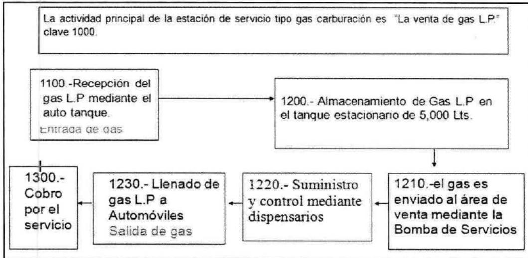
En traducción al diagrama anterior como descripción detallada se especifica que en la estación de servicio no se lleva a cabo ningún proceso productivo. El presente diagrama está referido a un proceso de servicio, el cual implica la compra y venta de gas L.P. para carburación se describen a continuación las diferentes actividades que se realizan en la estación de servicio:
