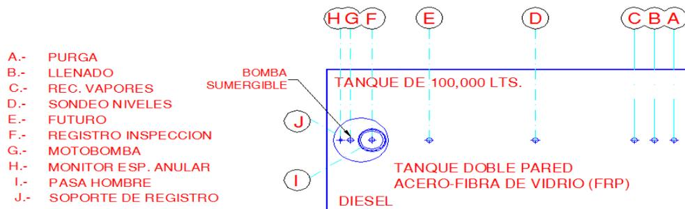
1. **Dispositivo de Llenado.**- en la parte posterior del tubo se colocará una conexión con tapa para descarga hermética. En su interior se alojará un tubo de aluminio de 76 mm (3") de diámetro mínimo, el cual llegará a 4" de fondo del tanque y estará integrado a la válvula de prevención de sobrellenado, cuyo punto de cierre se determinará a un nivel máximo equivalente al 95% de capacidad del tanque. El extremo inferior del tubo se cortará en diagonal.
