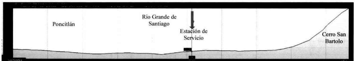
Figura 15. Sección Noreste-Suroeste de la zona de emplazamiento de la futura estación de servicio (flecha roja), la cual se localiza sobre una planicie inclinada hacia el SW, en general la zona tiene una pendiente del 1.9%.
