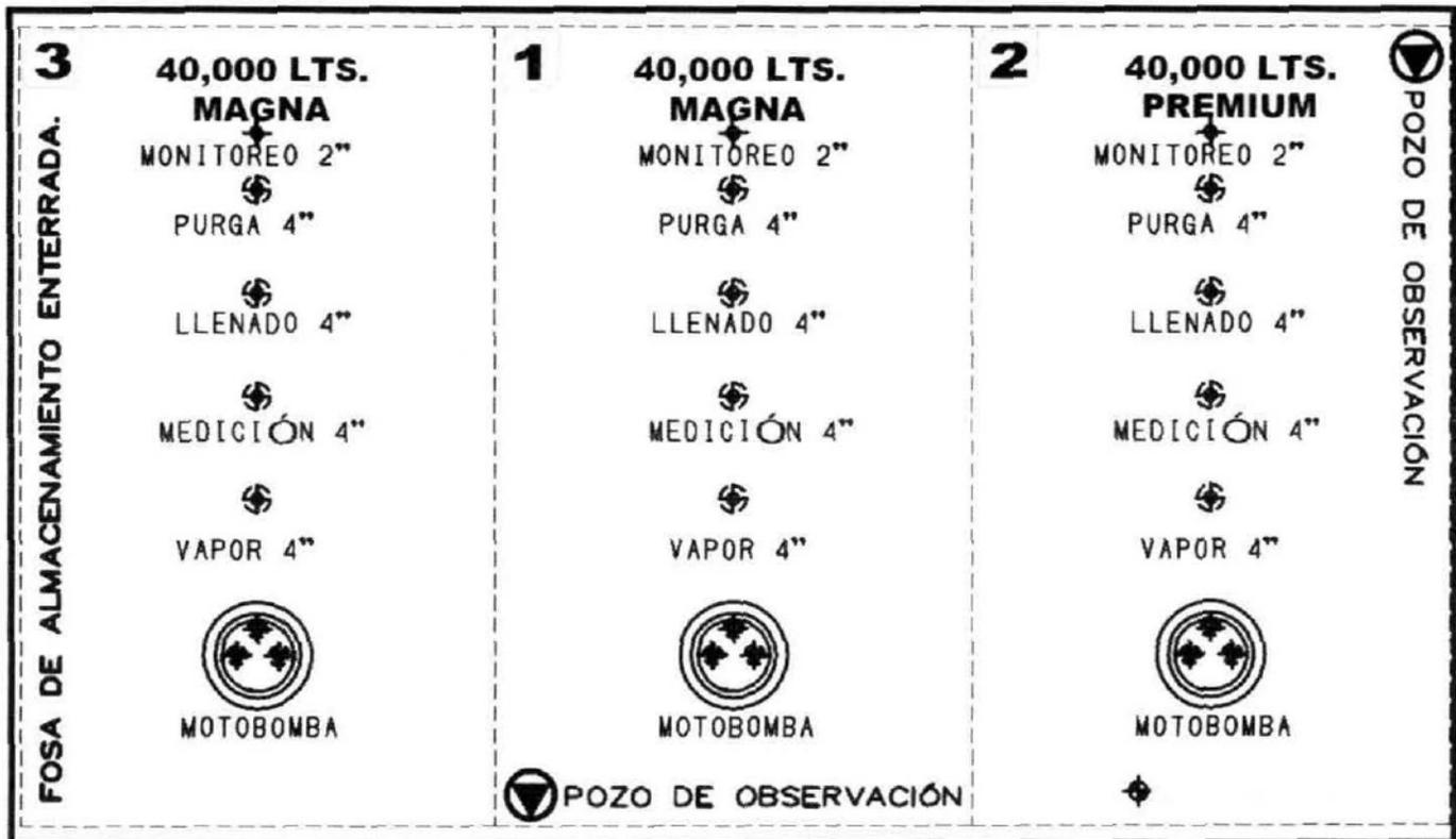
Imagen 9 Tanques de almacenamiento
