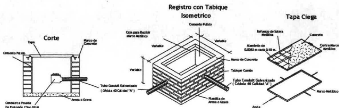
Figura III. 21. Detalle de registro con tabique.
