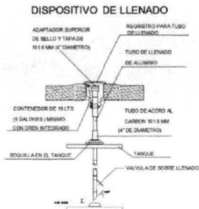
Figura III. 8. Detalle dispositivo de llenado.
