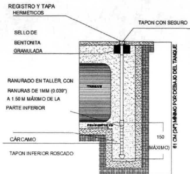
Figura III. 11. Detalle pozo de observación.
