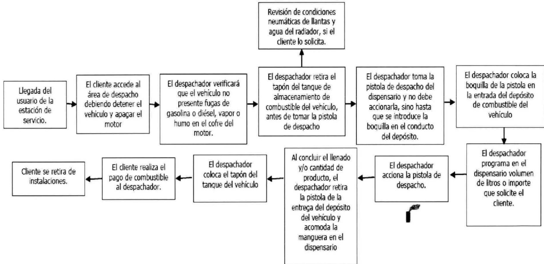
IMAGEN 8. Diagrama de proceso para despacho de combustible.
