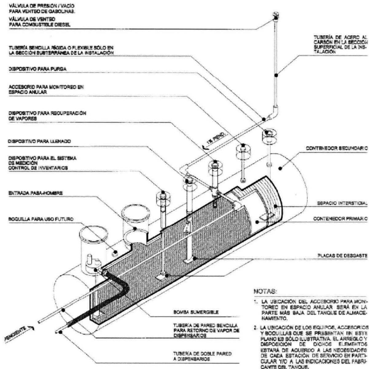
IMAGEN 11. Sistema de venteo en tanque de almacenamiento.
