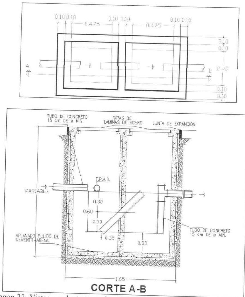
Imagen 23. Vistas en planta y en alzado de la Trampa de aceites y combustible.
