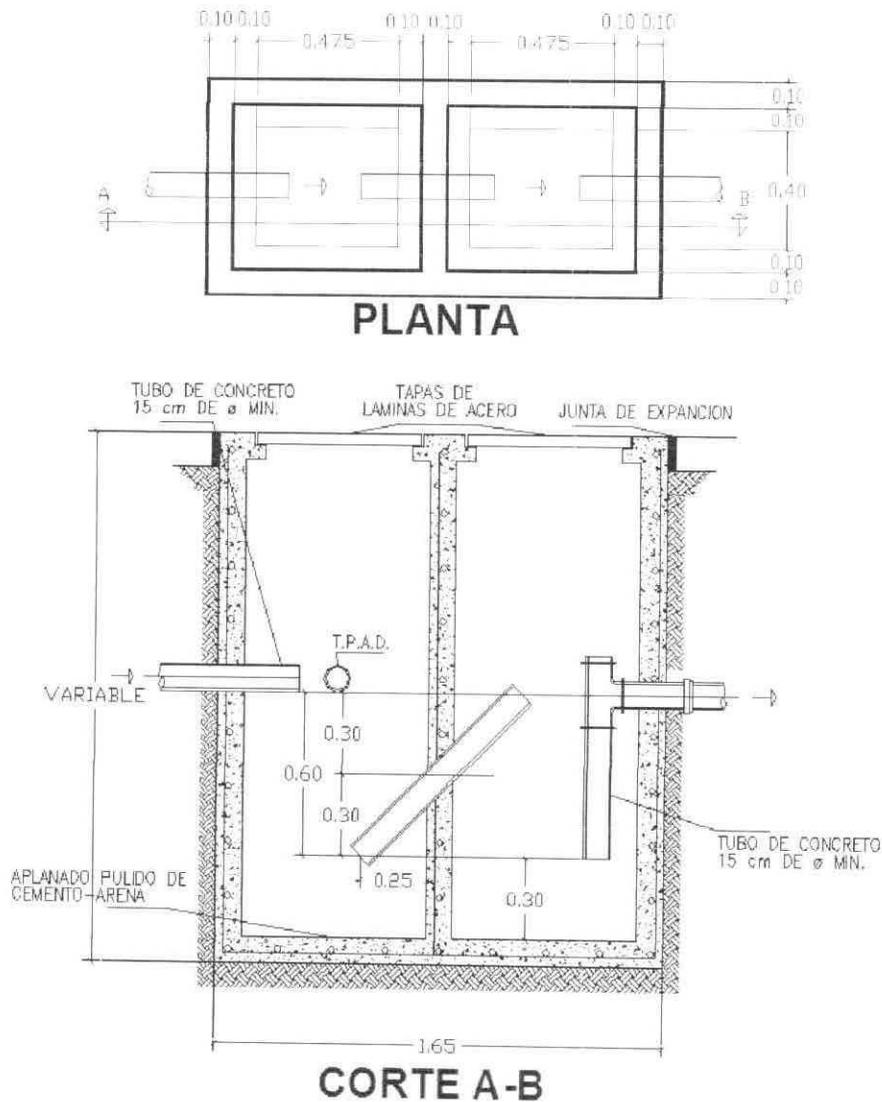
Imagen 9. Detalles de la Trampa de combustibles.
