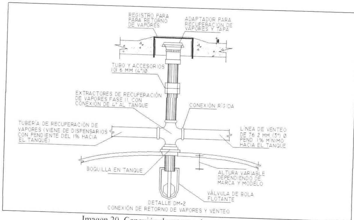
Imagen 20. Conexión de retorno de vapores y venteo.
