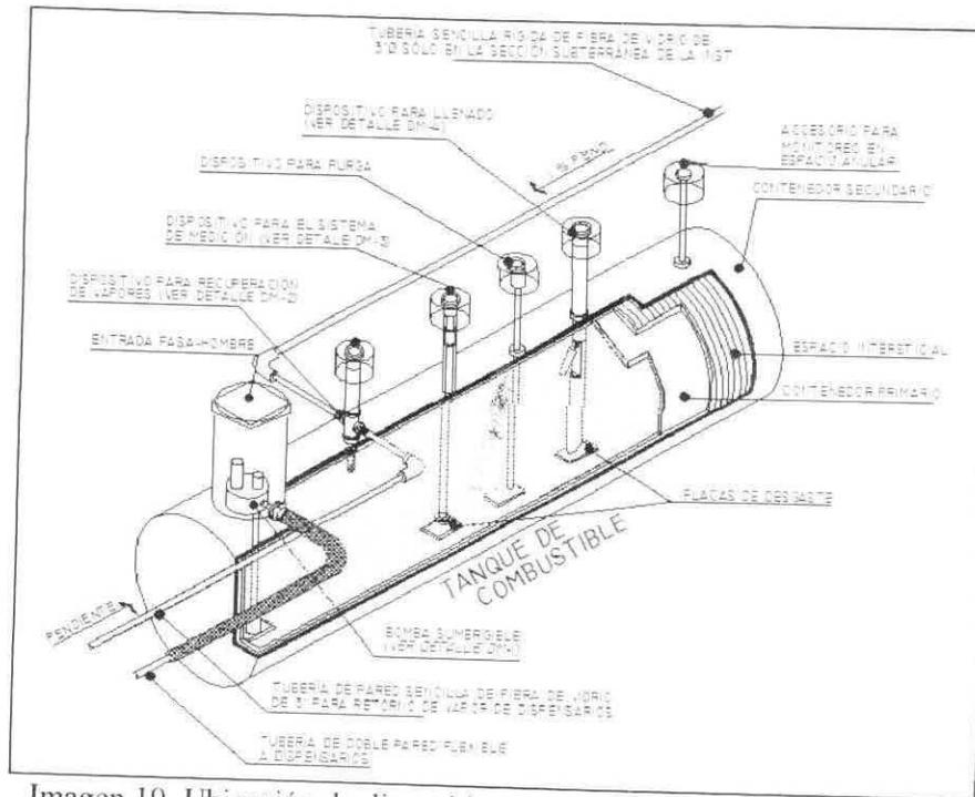
Imagen 19. Ubicación de dispositivos en el tanque de almacenamiento.
