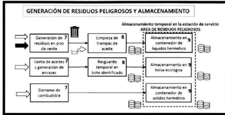
Ilustración 5. Generación de residuos peligrosos y almacenamiento
