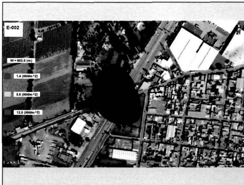
Figura III-53 Flama tipo jet origina por fuga en cruce carretero
