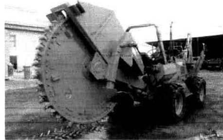
**Fotografías ilustrativas** de los trabajos que se realizarán con máquinas zanjadoras de rueda para la excavación de zanjas de 0.20 m de ancho para la instalación de tuberías de diámetros menores de 6" para los gasoductos de la red, en los derechos de vialidades existentes en la zona urbana.
