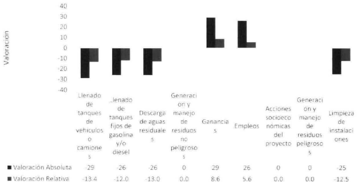
Durante la operación de la estación, los impactos más significativos, son generación por la pérdida de vapores al momento del llenado a tanques de automóviles y/o derrames de aceites, aditivos o combustible al suelo, así como la generación de las descargas de aguas residuales.
