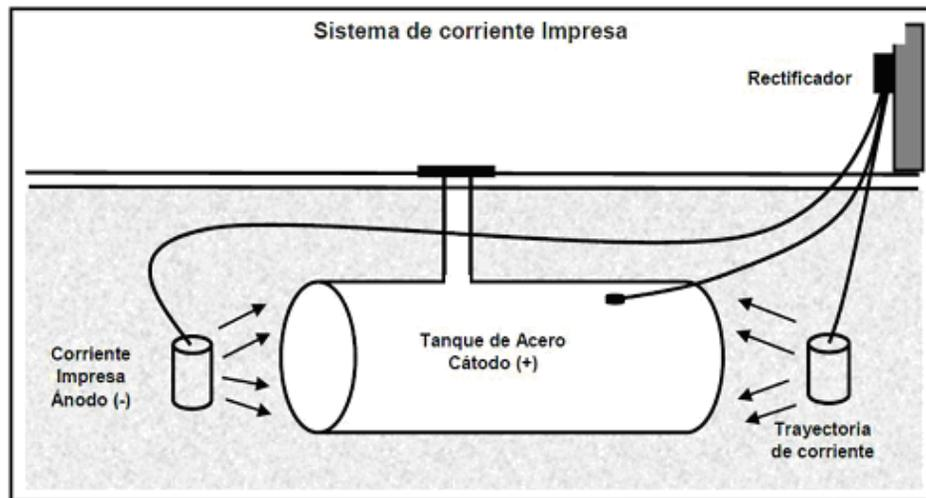
Figura 2. Sistema de protección catódica por corriente impresa
