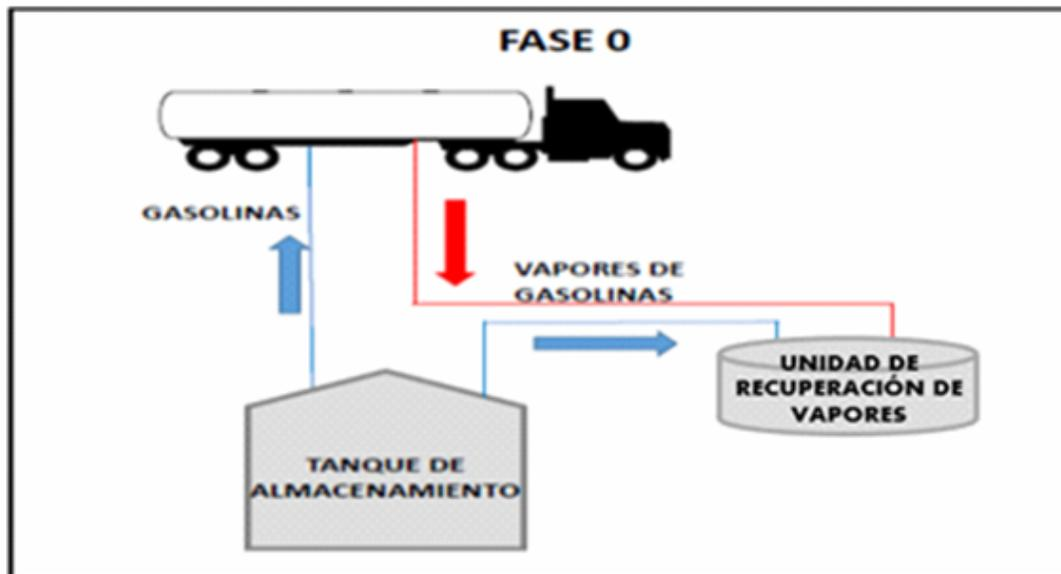
Figura 6. Fase 0 del Sistema de Recuperación de Vapores
