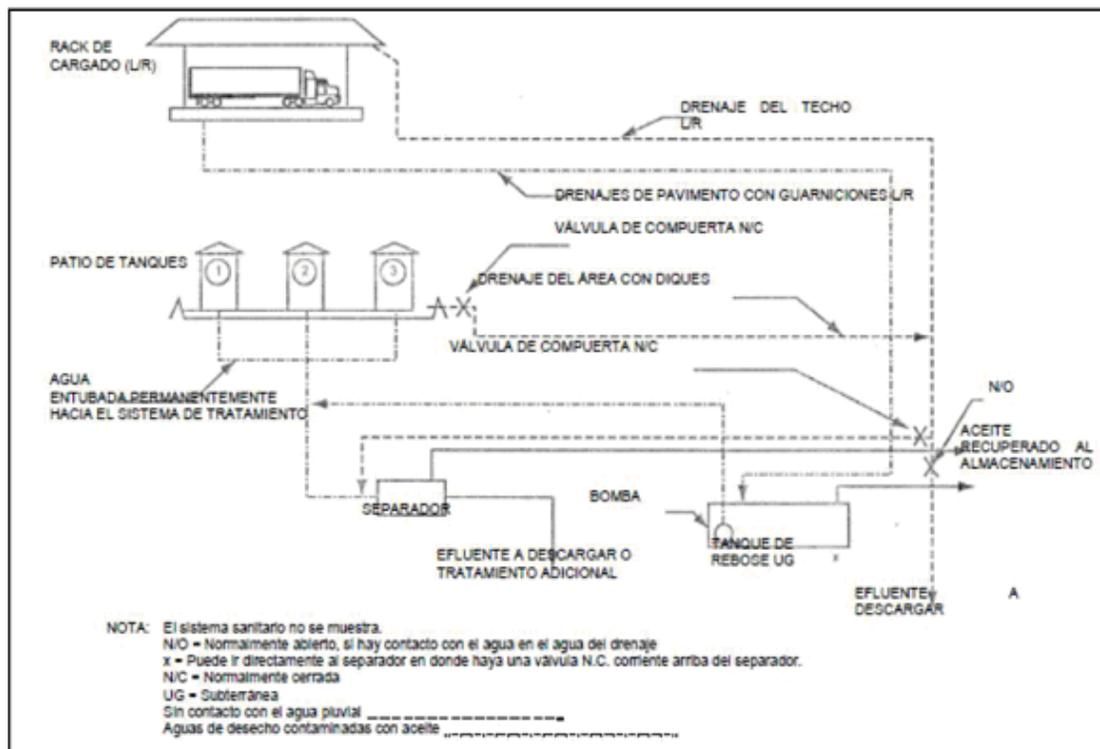
Figura 3. Sistema de Drenaje pluvial y aceitoso
