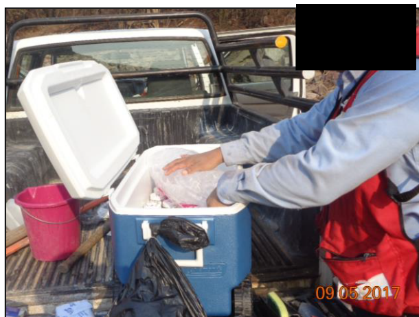
12. Preservación de muestras a una temperatura de 4°C.
