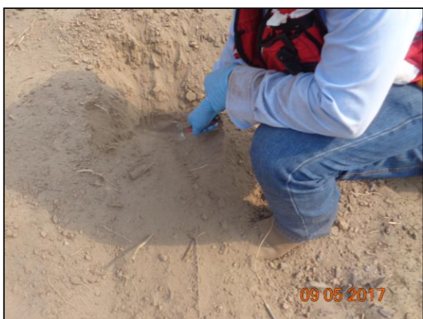
11. Toma de muestra a una profundidad superficial en el fondo de una de las fosas de excavación
