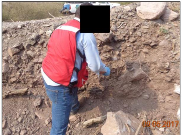
10. Toma de muestra con espátula de acero inoxidable en una de las paredes de las fosas de excavación.
