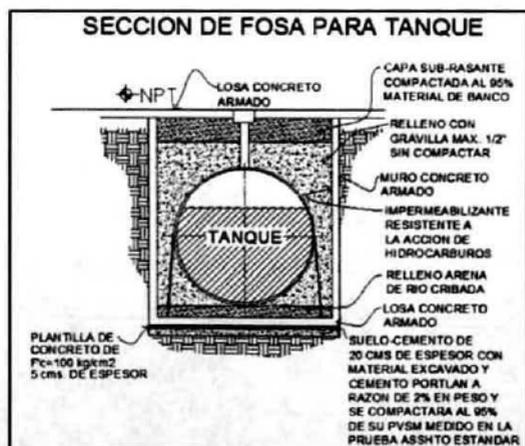
Corte transversal de la fosa de tanques.
