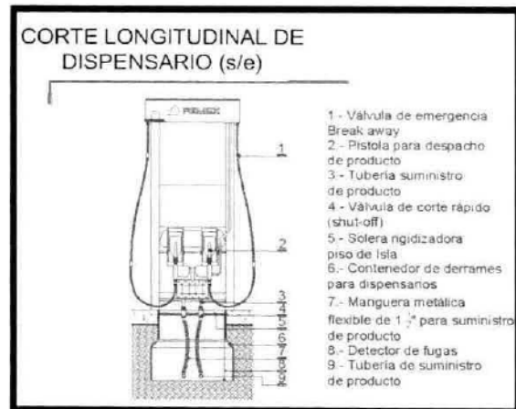
Corte transversal y longitudinal de los dispensarios de combustible
