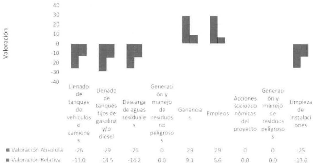
Durante la operación de la estación, los impactos más significativos, son generación por la pérdida de vapores al momento del llenado a tanques de automóviles y/o derrames de aceites, aditivos o combustible al suelo, así como la generación y manejo de residuos peligrosos y las descargas residuales.
