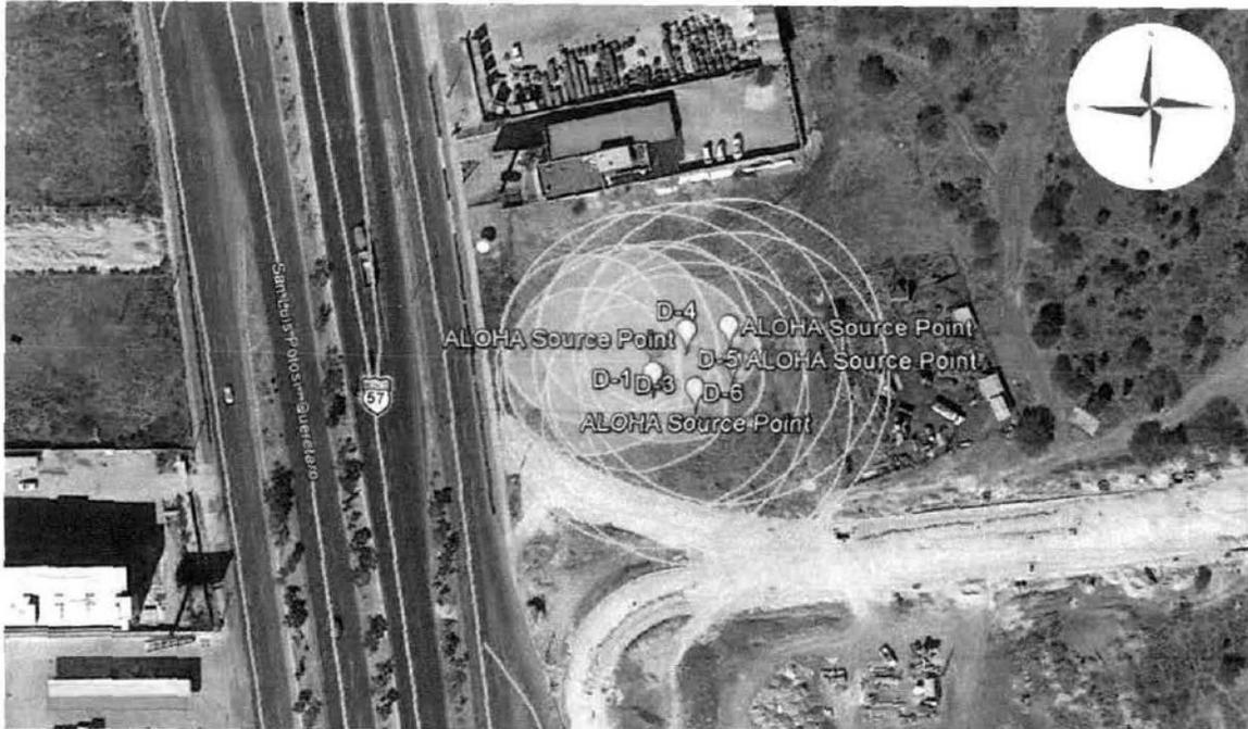
**Figura II.26 Radios de alto riesgo y amortiguamiento para una fuga transversal en todos los Dispensarios D-1,2,3,4,5,6 de gas natural.
