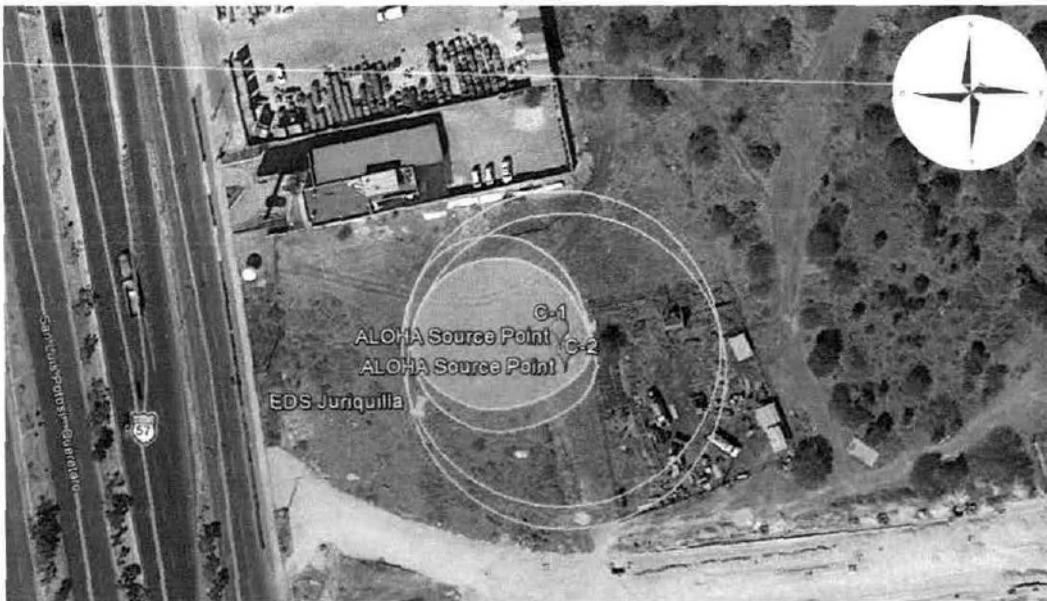
Figura II.12 Radios de alto riesgo y amortiguamiento para una fuga transversal en compresores-C 1 y C 2- de gas natural.
