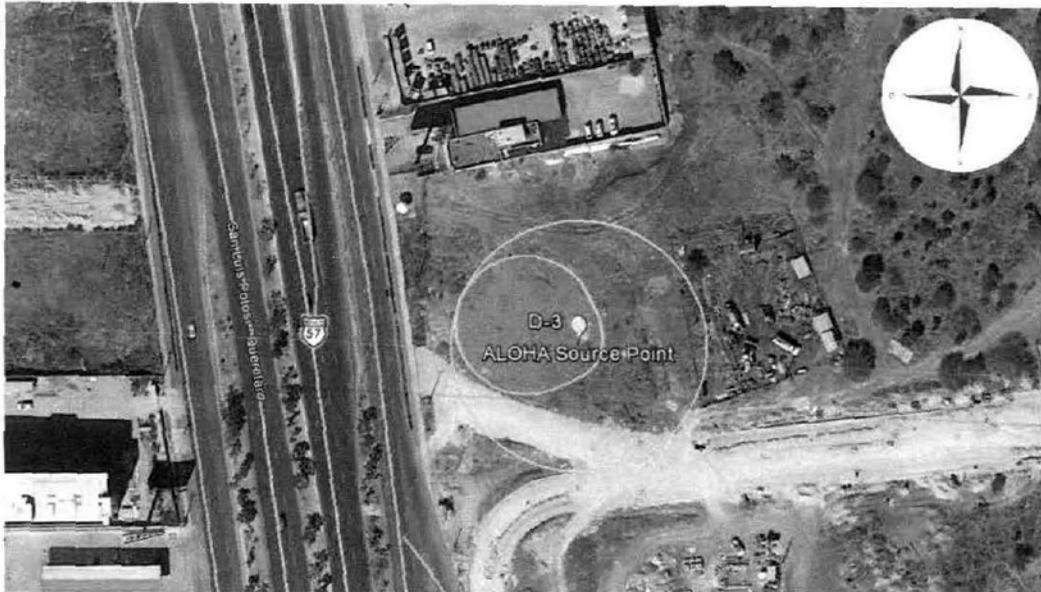
Figura II.22 Radios de alto riesgo y amortiguamiento para una fuga transversal en el Dispensario D-3 de gas natural.
