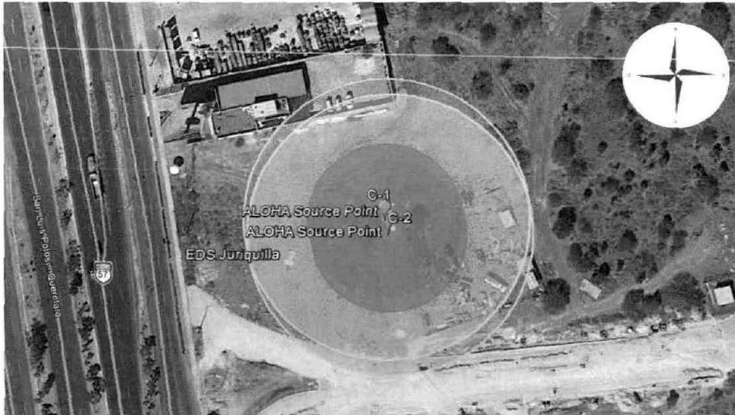
**Figura II.9 Radios de alto riesgo y amortiguamiento para una fuga transversal en compresores-C 1 y C 2- de gas natural.**
