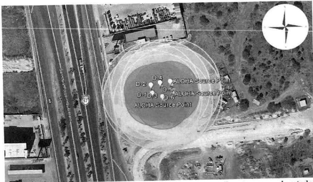
**Figura II.19 Radios de alto riesgo y amortiguamiento para una fuga transversal en todos los Dispensarios D-1,2,3,4,5,6 de gas natural.**
