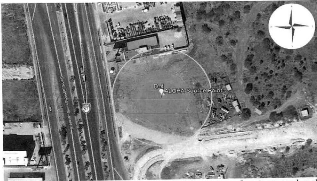
**Figura II.16 Radios de alto riesgo y amortiguamiento para una fuga transversal en el Dispensario D-4 de gas natural.**
