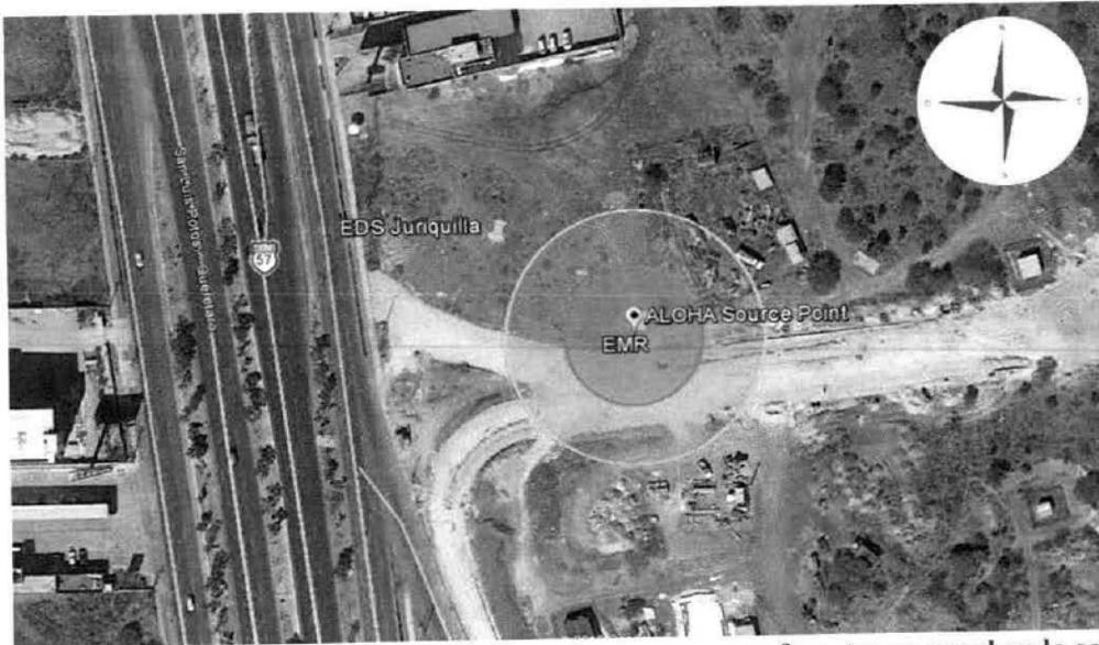
**Figura II.5** Radios de alto riesgo y amortiguamiento para una fuga transversal en la salida de la estación de regulación y medición a 9.81 bar de presión.
