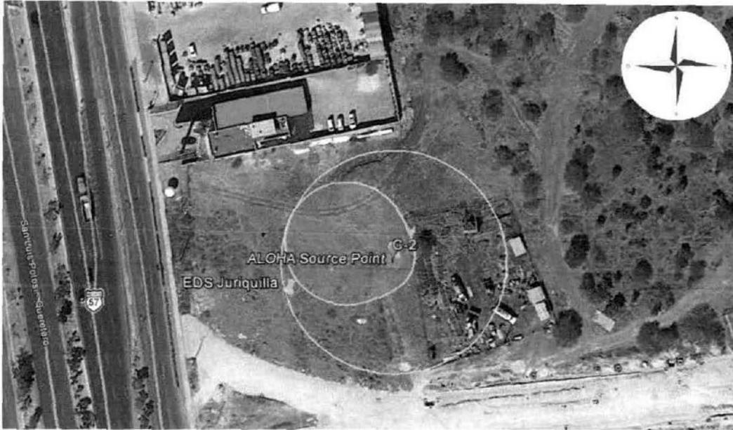
Figura II.11 Radios de alto riesgo y amortiguamiento para una fuga transversal en el compresor C-2 de gas natural.
