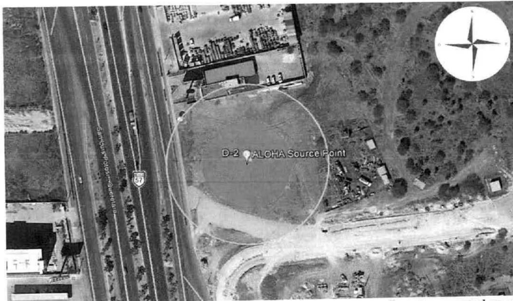
**Figura II.14** Radios de alto riesgo y amortiguamiento para una fuga transversal en el Dispensario D-2 de gas natural.
