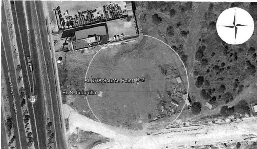
**Figura II.8 Radios de alto riesgo y amortiguamiento para una fuga transversal en el compresor C-2 de gas natural.**
