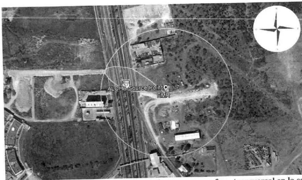
**Figura II.6** Radios de alto riesgo y amortiguamiento para una fuga transversal en la salida de la estación de regulación y medición a 9.81 bar de presión.
