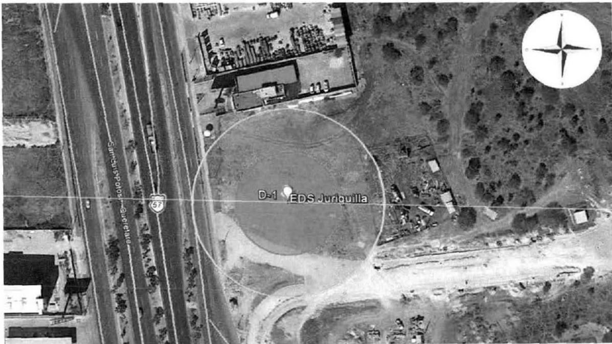
**Figura II.13 Radios de alto riesgo y amortiguamiento para una fuga transversal en el Dispensario D-1 de gas natural.**
