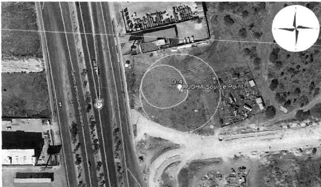
Figura II.23 Radios de alto riesgo y amortiguamiento para una fuga transversal en el Dispensario D-4 de gas natural.
