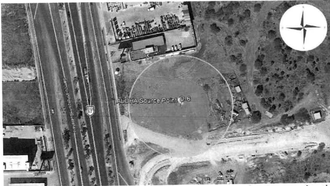
**Figura II.18 Radios de alto riesgo y amortiguamiento para una fuga transversal en el Dispensario D-6 de gas natural.**
