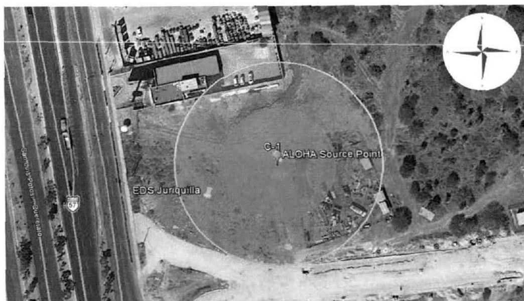
**Figura II.7 Radios de alto riesgo y amortiguamiento para una fuga transversal en el compresor C-1 de gas natural.**
