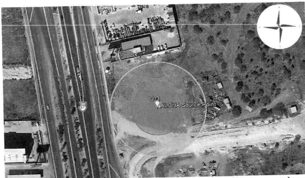
**Figura II.15** Radios de alto riesgo y amortiguamiento para una fuga transversal en el Dispensario D-3 de gas natural.
