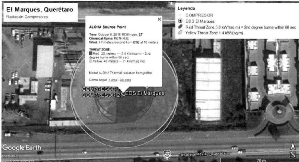
**Figura II.12 Radios de alto riesgo y amortiguamiento para una fuga transversal en compresores C-1 y C 2- de gas natural.**
