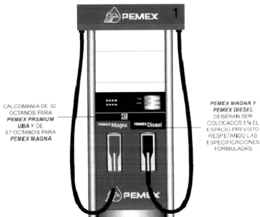
Identificación de productos en dispensarios para Pemex-Magna Pemex-Diésel
