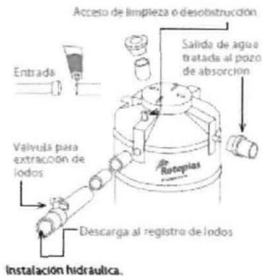
Ensamblar la tubería de entrada y salida. Sellar con pegamento para PVC los puntos de unión de las interconexiones; las partes roscadas sólo llevarán cinta teflón.
