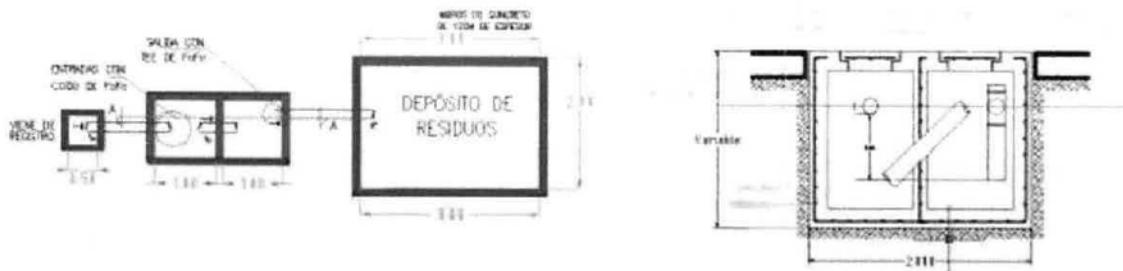
Ilustración 31. Depósito de Residuos
