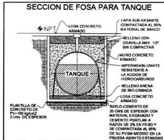
Imagen 11. Corte transversal de la fosa de tanques.
