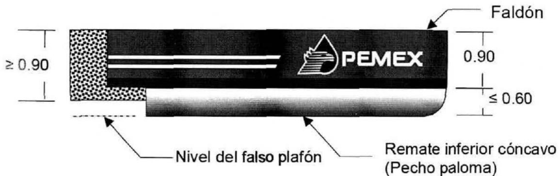
Ilustración que muestra el diseño del faldón perimetral adosado a la techumbre, siguiendo los lineamientos y especificaciones de PEMEX.
