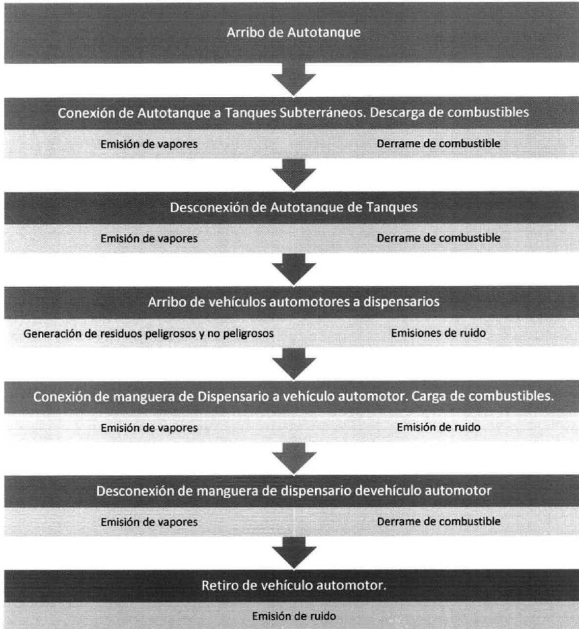
Se puede observar el proceso de descarga de combustible del auto tanque al tanque de almacenamiento, la carga de combustibles a los vehículos por los dispensarios y el retiro de vehículos de la estación. Indicándose los puntos de emisión de vapores contaminantes a la atmósfera, el posible derrame o fuga de combustible y la generación de residuos peligrosos y
