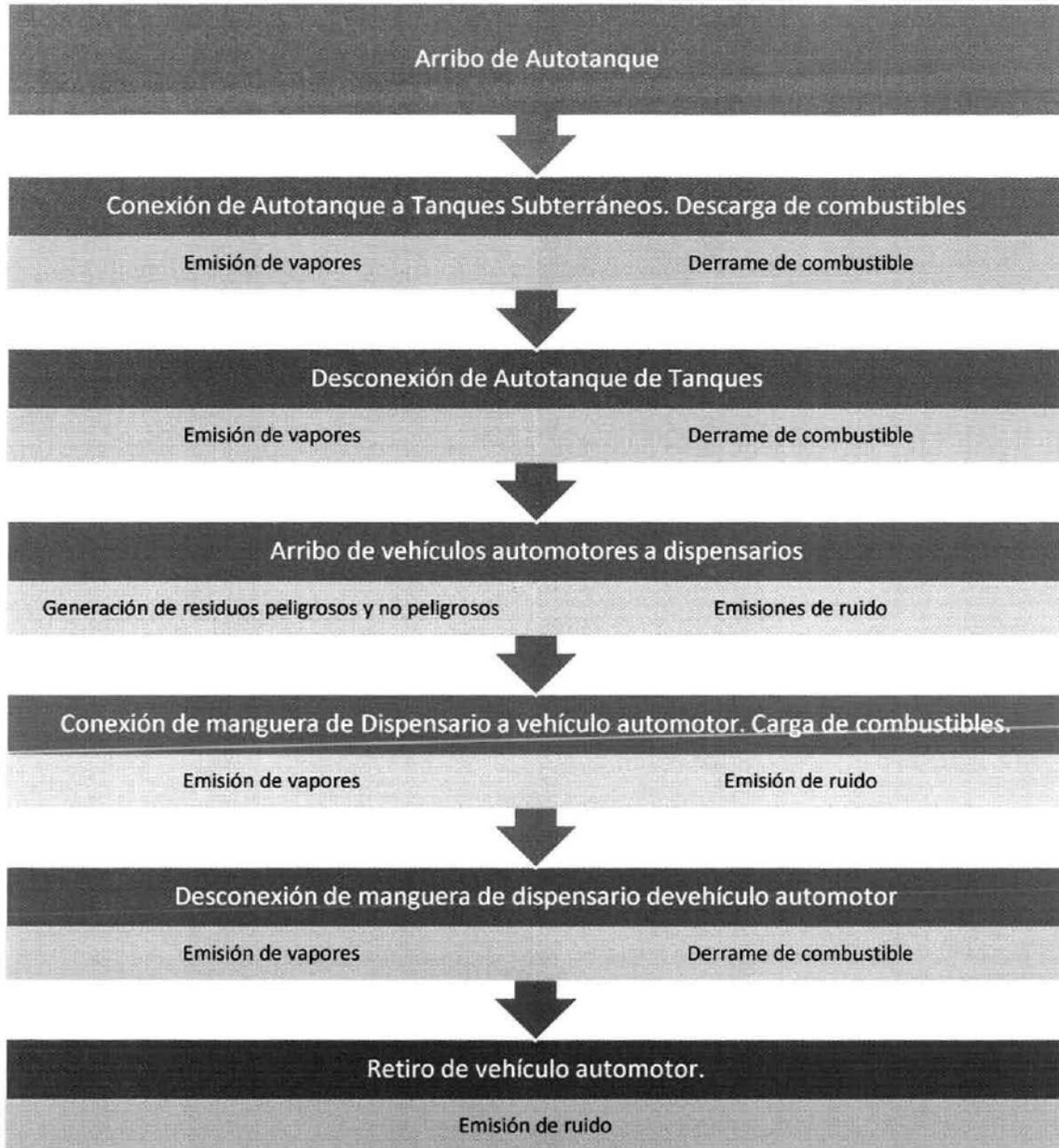
Se puede observar el proceso de descarga de combustible del auto tanque al tanque de almacenamiento, la carga de combustibles a los vehículos por los dispensarios y el retiro de vehículos de la estación. Indicándose los puntos de emisión de vapores contaminantes a la atmósfera, el posible derrame o fuga de combustible y la generación de residuos peligrosos y no peligrosos.
