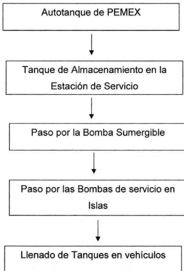
Dado que el funcionamiento de una gasolinera no implica la transformación de materias primas en producto terminado, se destacan los siguientes aspectos importantes para la operación de una estación de servicio. Se incluyen **anexo 6**, plano aprobado por PEMEX.
