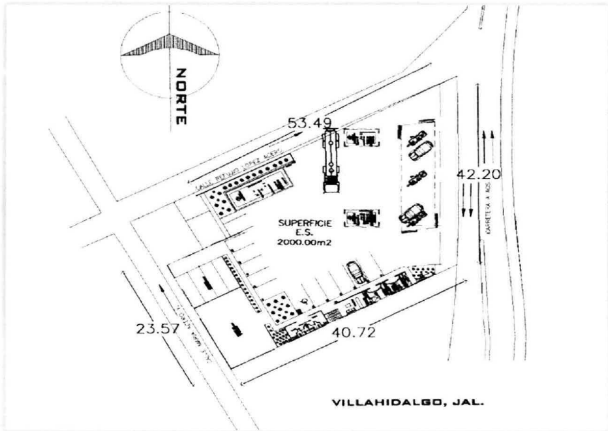
Figura 2. Superficie y colindancias de la estación de servicio
