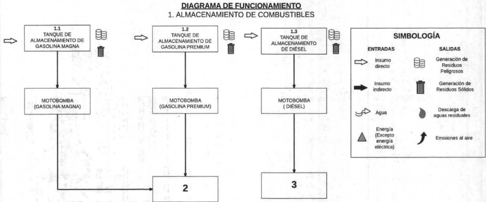
Imagen III.25 Diagrama de funcionamiento específico de la actividad “Almacenamiento de combustibles”.
