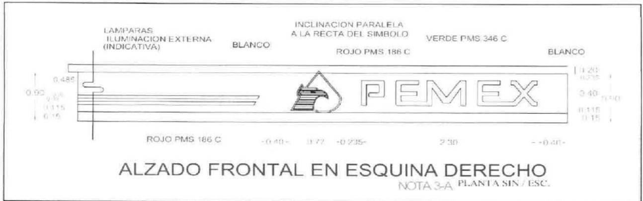
**Figura 14.** Ilustración que muestra el diseño del faldón perimetral adosado a la techumbre, siguiendo los lineamientos y especificaciones de PEMEX-REFINACIÓN (Hoy Pemex Logística) y la ASEA.
