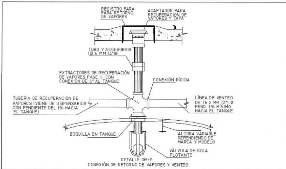
Figura 13. Conexión de retorno de vapores y venteo.
