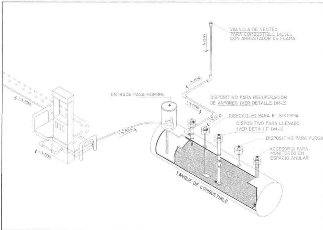
Figura 10. Ejemplo del dispositivo de recuperación de vapores.
