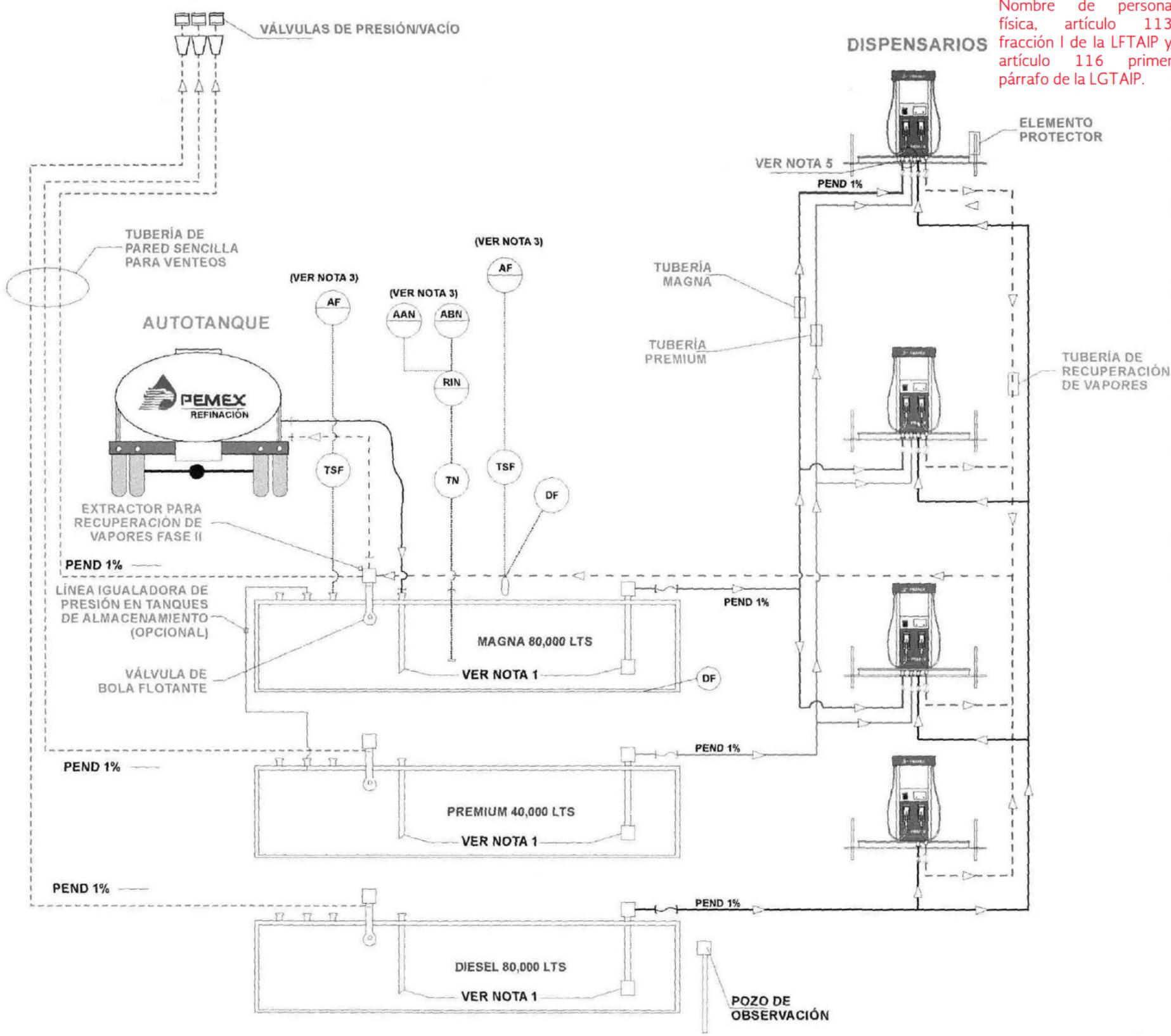
**DIAGRAMA MECÁNICO DE FLUJO DE UNA ESTACIÓN DE SERVICIO**
