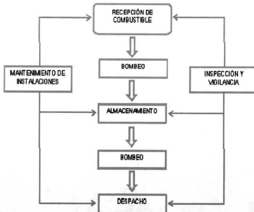
Figura III.4.- Diagrama de la operación de la estación de servicio.
