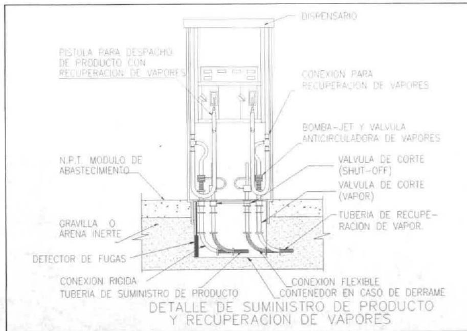
Figura 12. Detalle de suministro de producto y recuperación de vapores.
