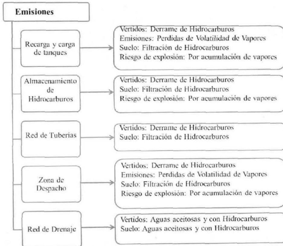
Figura 6. Diagrama de las emisiones en las áreas de las Estaciones de Servicio.
