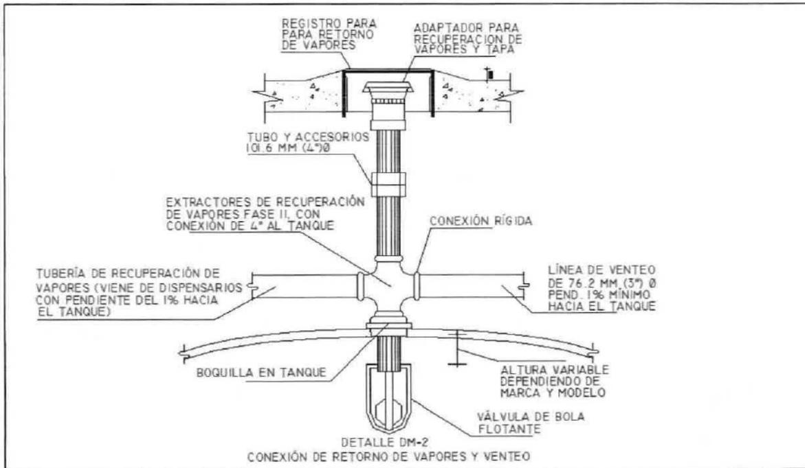
Figura 11. Conexión de retorno de vapores y venteo.
