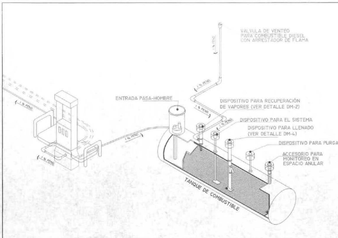
Figura 8. Ejemplo del dispositivo de recuperación de vapores.
