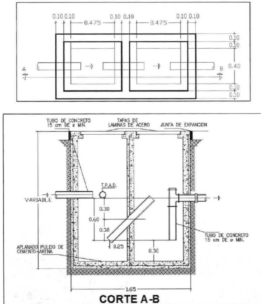
Figura 14. Vistas en planta y en alzado de la Trampa de aceites y combustibles.
