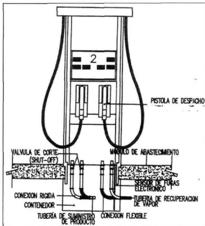
Figura 18. Ejemplo de dispositivos de seguridad con los que cuentan los dispensarios.
