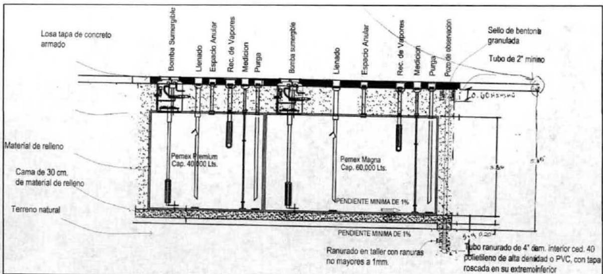
Figura 17. Ejemplo de sistemas de seguridad de los tanques de almacenamiento.
