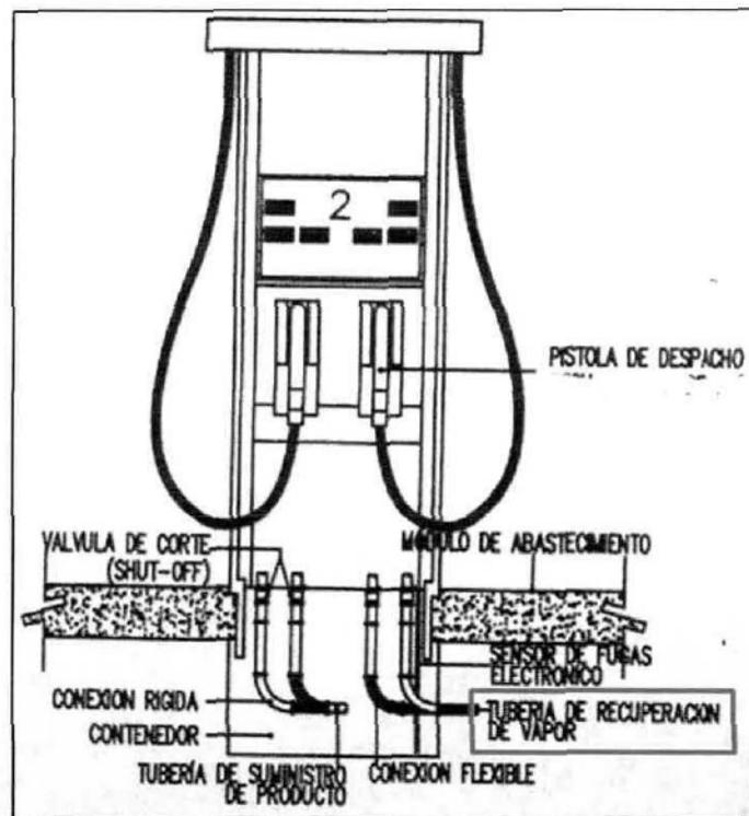
Figura 15. Ejemplo del sistema recuperador de vapores en los dispensarios.
