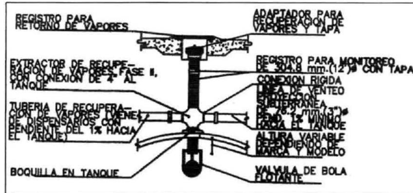
Figura 16. Detalles del sistema de recuperación de vapores.
