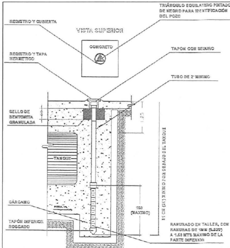
Figura 19. Ejemplo de las características del pozo de observación.
