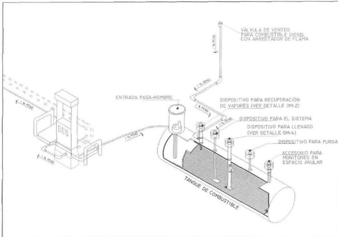
Figura 12. Ejemplo del dispositivo de recuperación de vapores.
