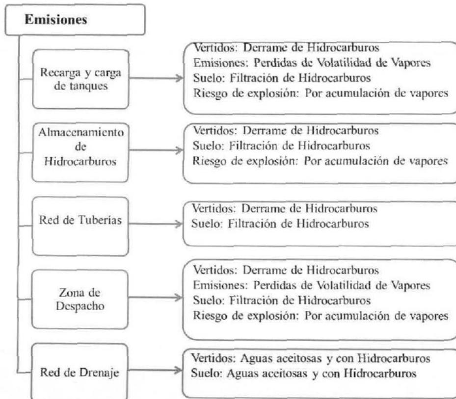
Figura 5. Diagrama de las emisiones en las áreas de las estación de servicios.
