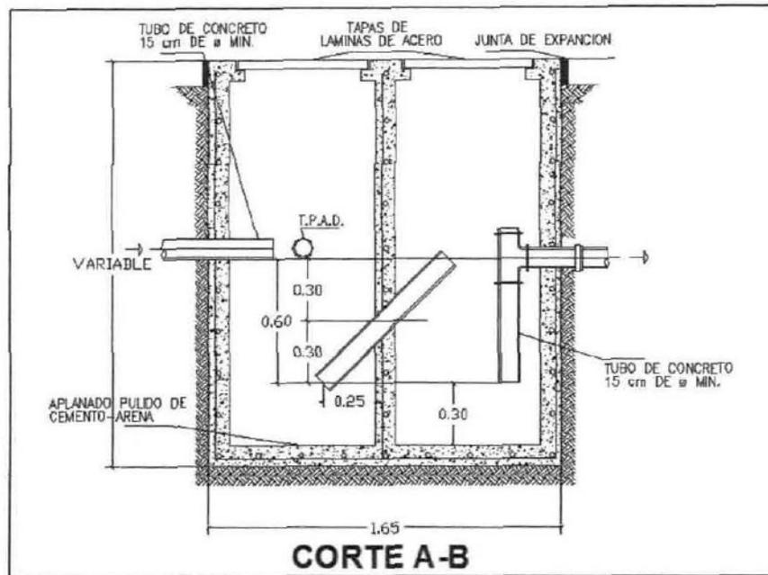
Figura 18. Vistas en planta y en alzado de la Trampa de aceites y combustible.
