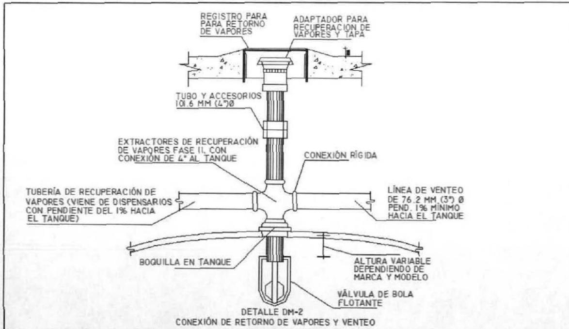
Figura 15. Conexión de retorno de vapores y venteo.
