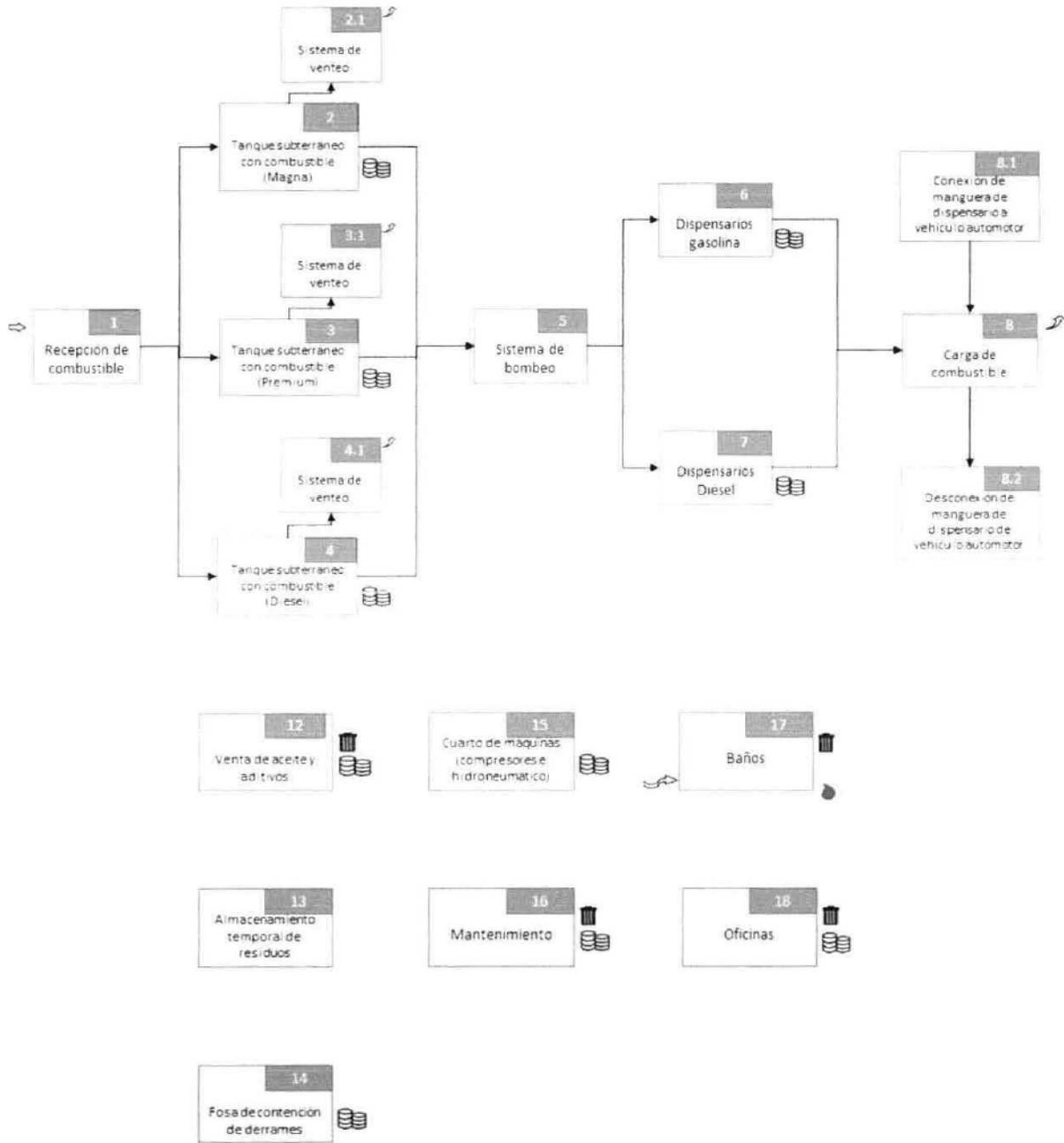
Figura III.6. Diagrama de funcionamiento de la estación de servicio.
