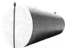
Los recipientes de almacenamiento son metálicos, contruidos con doble pared y espacio anular (tanque primario de placa de acero fabricado bajo la Norma UL y el secundario de placa de acero bajo la Norma UL), monitoreados con sensores para derrame de líquidos.
