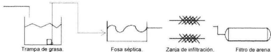
El sistema de tratamiento se diseñó en base a lo estipulado en las NOM's que a continuación se mencionan: NOM-006-CONAGUA-1997. Fosas sépticas prefabricadas - Especificaciones y métodos de prueba y la NOM-014-CONAGUA-2003, Requisitos para la recarga artificial de acuíferos con agua residual tratada.
