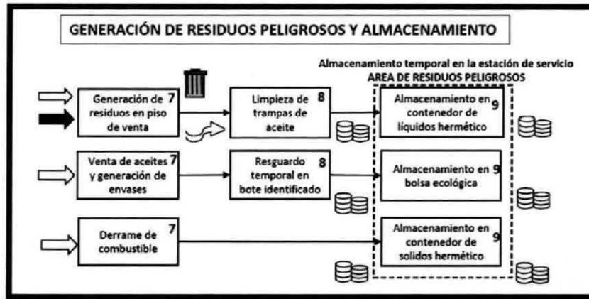
Ilustración 4. Generación de residuos peligrosos y almacenamiento.
