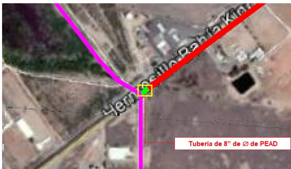
Figura 3.3. Tubería de 8" de Ø de Polietileno de Alta Densidad.
