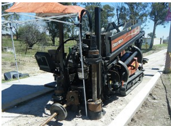
Imagen ilustrativa: perforadora direccional de las utilizadas por la empresa para los cruces subterráneos.
