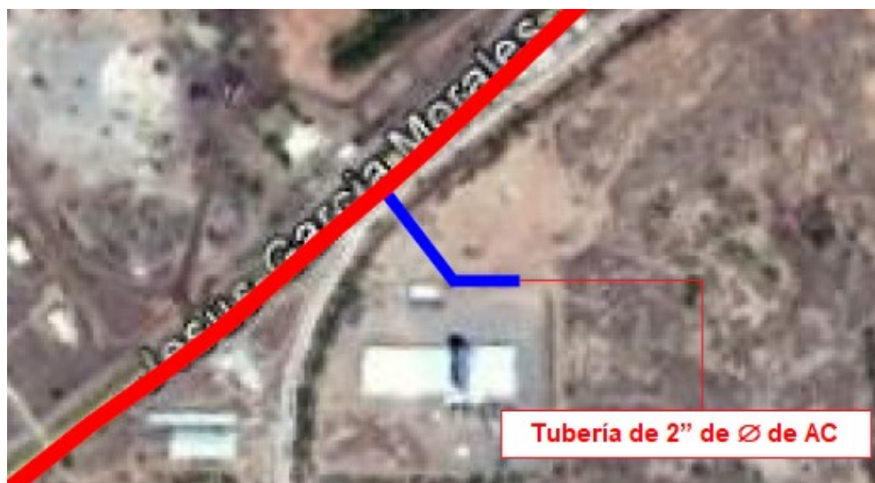
Figura 3.2. Tubería de 2" de Ø de Acero al Carbón.
