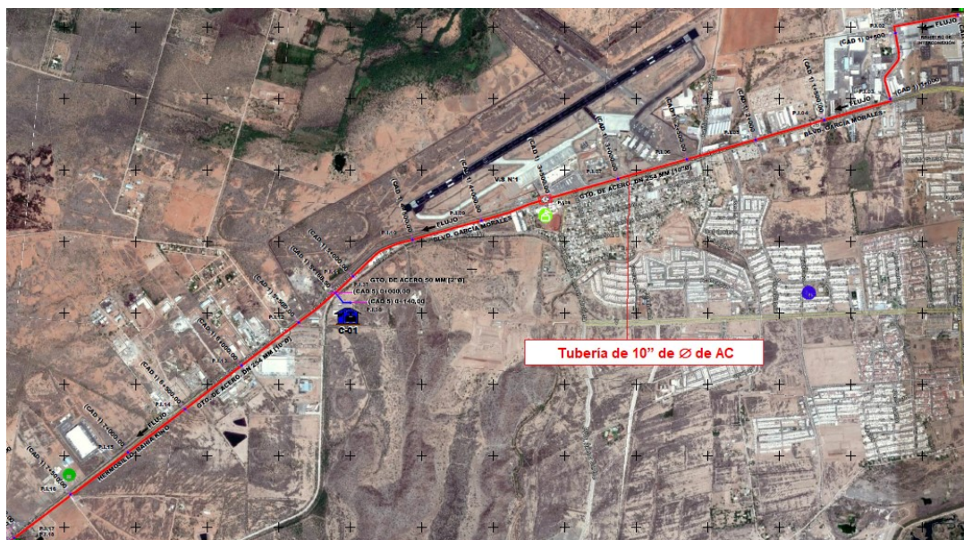
Figura 3.1. Tubería principal del gasoducto ACUÍCOLA Hermosillo, de 10" de \varnothing de Acero al Carbón.
