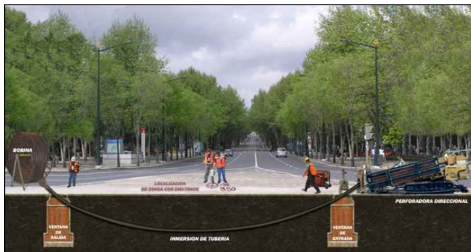
Figura 5.1. Imagen que muestra la forma de excavación de una perforadora direccional para el cruce subterráneo de tuberías, en este caso para un gasoducto, sin afectar la infraestructura vial.
