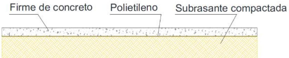
Fig. # 3. Piso de diques de contención
