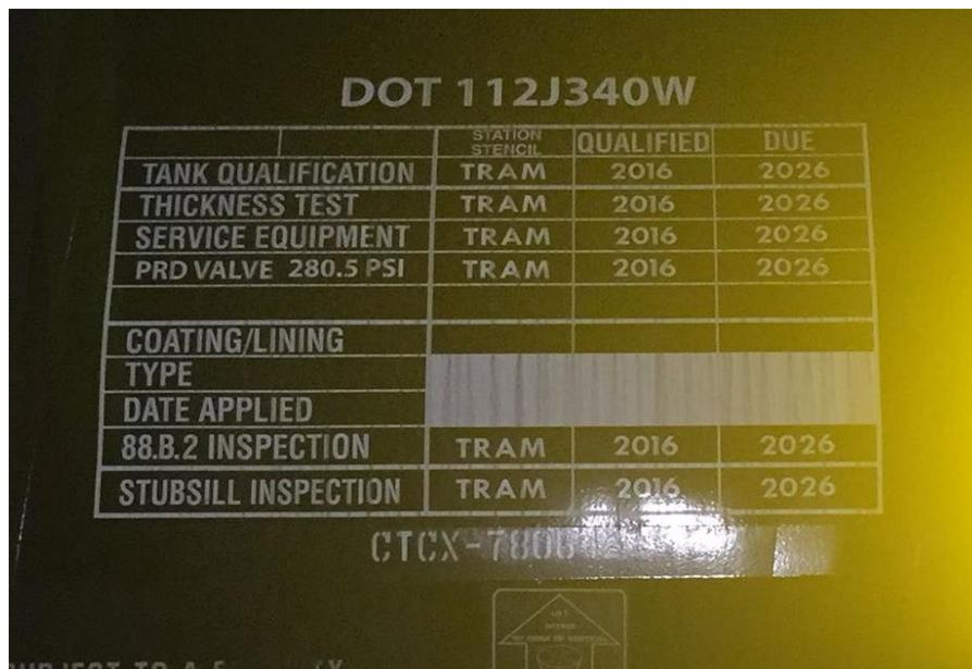
Fig. # 15. Placa de Diseño de Carro-tanque.
