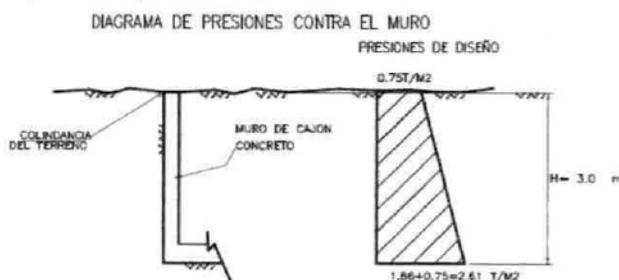
Por otra parte los resultados del análisis de estabilidad de taludes indican que para mantener las excavaciones estables durante la construcción de muros perimetrales de fosas enterradas, es admisible realizar cortes verticales. Sin embargo, debido a la presencia de estructuras colindantes y los materiales que existen superficialmente en el terreno, la excavación en el perímetro se realizará dejando taludes en esas zonas con una inclinación de 1: 1 (horizontal a Vertical).
