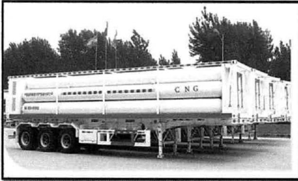
Las **unidades móviles** constan de 11 tanques salchicha, cada uno con una longitud de 40 ft (12.19 metros) y un diámetro de 0.559 metros, dichos tanques pueden soportar presiones del orden de 250 bar; durante la operación, una vez que las unidades móviles estén vacías, estas se cambiarán por una nueva unidad cagada, en tanto la otra se envía a recarga con el proveedor.
